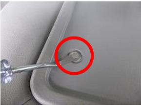
1、バックテーブルのピンを内張りはがしなどを使用し取り外します。赤丸のように中心部分のみ引っ張りあげると取り外せます。
