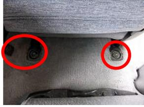
2、後方にある赤丸のボルトをボックスレンチ(14mm)を使用し、取り外します。※3箇所
