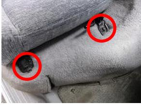
1、前方にある赤丸のボルトをボックスレンチ(14mm)を使用し、取り外します。※2箇所
