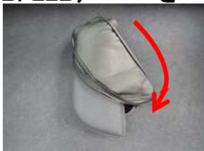
6、背もたれ外側のパーツは上部からカバーを被せます。
