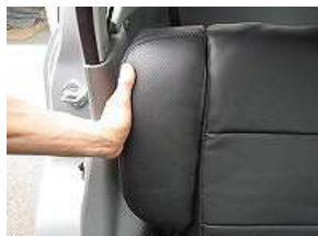
11、カバーにより厚みが増すので、 背もたれに戻す際は、力を加えて 押さえながら取付て下さい。
