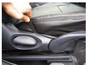
5、付属のヘラを使用して、側面のプラスチック部の中にカバーを入れ込みます。
