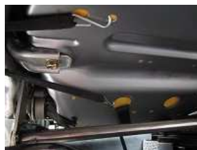
7、6で取り付けしたS字フックをシート下の金属部に引っ掛け固定します。
