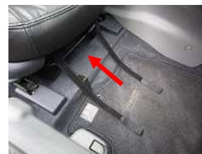
8、カバー前方のバンドはシート下を通します。 ※シート下を通す際は、シートの可動の妨げにならない箇所を通して下さい。
