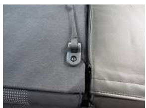
13、助手席背もたれの裏側にはベ ルトが装備されています。カバーを 取り付ける前に台座のネジを緩 め、台座を取り外して下さい。
