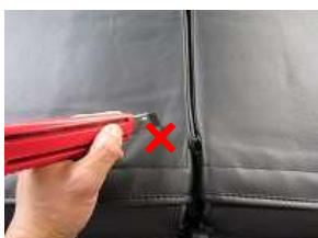
14、カバーを正確に被せた後、台 座のネジを通す切れ込みを入れて 下さい。
