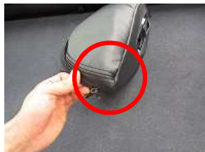
7、パーツ下側の角はカバーとシート のラインをしっかりと合わせて下 さい。
