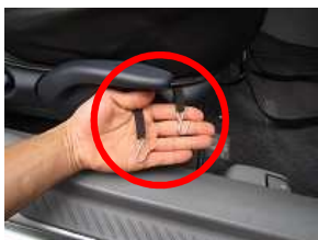
6、側面のバンドに付属のS字フックを取り付けます。
