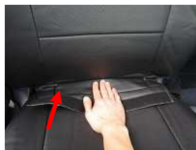
5、座面との隙間にカバーを入れ込みます。カバーの端は付属のヘラを使用し入れ込んで下さい。
