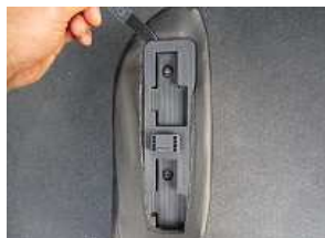
9、背もたれへの取付面の内側に、 ヘラを使用しカバーを入れ込みま す。
