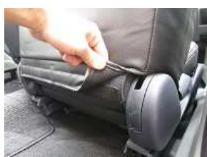
7、シート背面のマジックテープを固定します。
