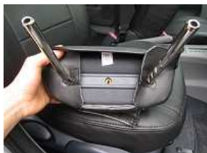
3、背もたれより取り外し、シャフト 部のマジックテープを固定します。
