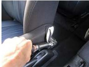
2、ボックスレンチを使用し、中のボルトを外しアームレストを取り外します。
