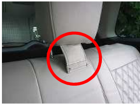
10、センターヘッドレストはマジックテープのメス側が前にくるようにカバーを被せ取り付けて下さい。
